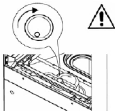
Vérifier que le sens de rotation correspond à l'illustration et aux marquages sur le mouvement de traction central.
